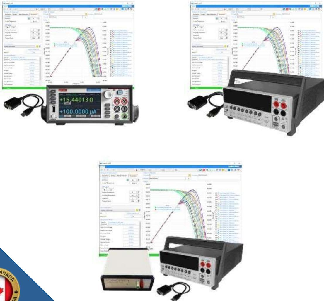
Le SSIIVT est un système complet de mesure de courant-tension (I-V) utilisé pour caractériser les performances des cellules photovoltaïques. Le système de mesure I-V comprend :
